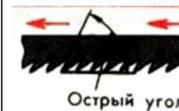
древесины, и отрезанные частички скалываются вдоль волокон, образуя опилки.
